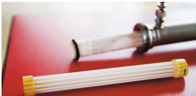
Beispielhafter Aufbau einer Polymermembran im Labormaßstab
